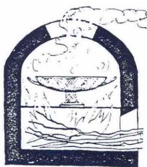
1. Dans un premier temps, la température ne dépasse pas 800°. L'air pénètre dans le four : l'argile passe du brun au rouge.
