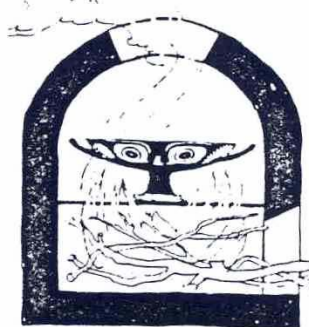
3. On ouvre à nouveau le four et on laisse retomber la température vers 875° : les parties peintes imperméables à l'air restent noires, les autres non peintes redeviennent rouges.
